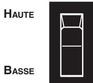
Ce commutateur sert à contrôler la vitesse du ventilateur (ventilation) de la fournaise. La ventilation peut être contrôlée par le thermostat, même s'il n'y a pas de commande pour de la chaleur; la vitesse du ventilateur est déterminée par ce commutateur.
